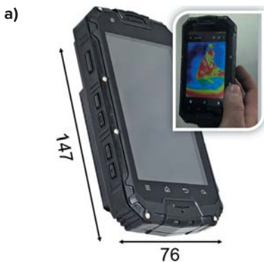
Рис. 5 Переговорное устройство (смартфон) для обеспечения мобильной телефонной связи в системе «SBGPS-R»: а – вид общий; б – технические характеристики
