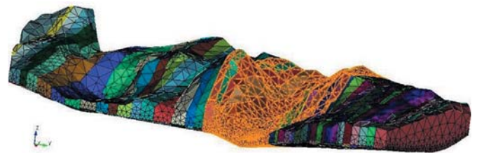
Рис. 3 Разбиение модели на конечные элементы
