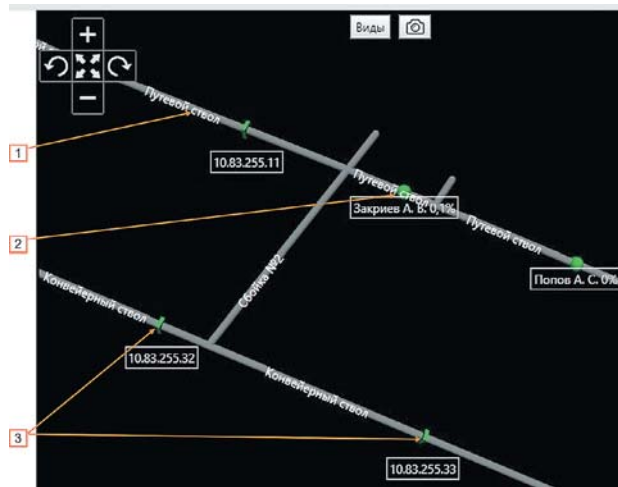
Рис. 4 Масштабная схема шахты (фрагмент) с расстановкой базовых станций в капитальных выработках: 1 – горные выработки; 2 – местоположение персонала; 3 – базовая станция подземной инфраструктуры связи
