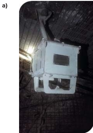
Рис. 5 Стационарная базовая станция SBGPS Master: а) пример монтажа под кровлей выработки; б) технические характеристики
