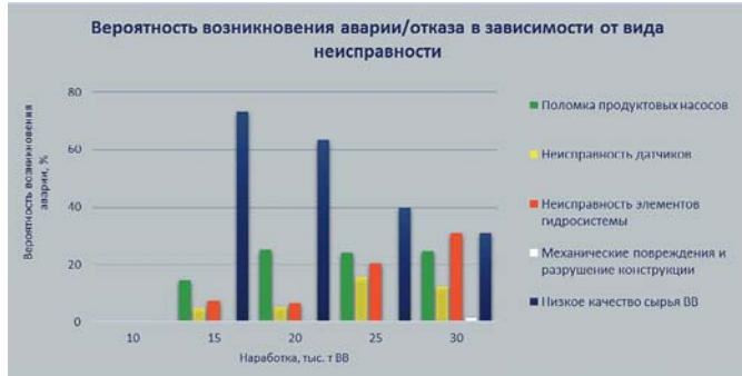
Рис. 3 Вероятность возникновения аварии/отказа в зависимости от вида неисправности в разные периоды наработки
