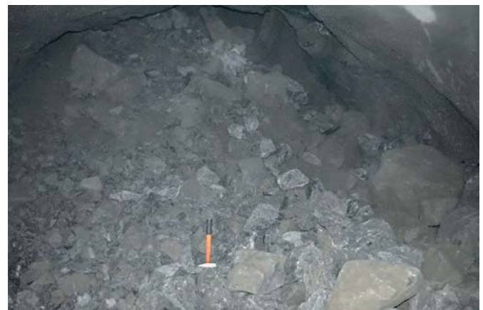
Рис. 12 Фракционный состав после выпуска 2861 т руды при взрыве веера с интервалом замедления между группами скважин 20 мс
