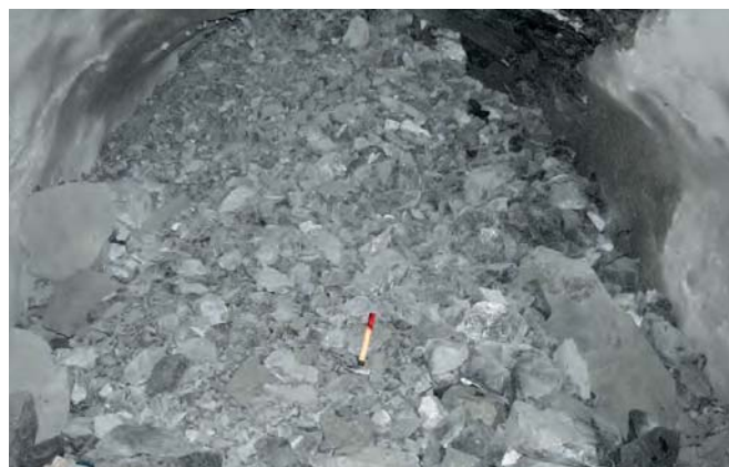
Рис. 8 Фракционный состав после выпуска 805 т руды при взрыве веера с интервалом замедления между группами скважин 10 мс
