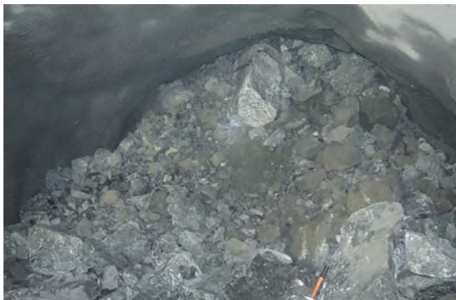
Рис. 10 Фракционный состав после выпуска 2679 т руды при взрыве веера с замедлением между группами скважин 15 мс
