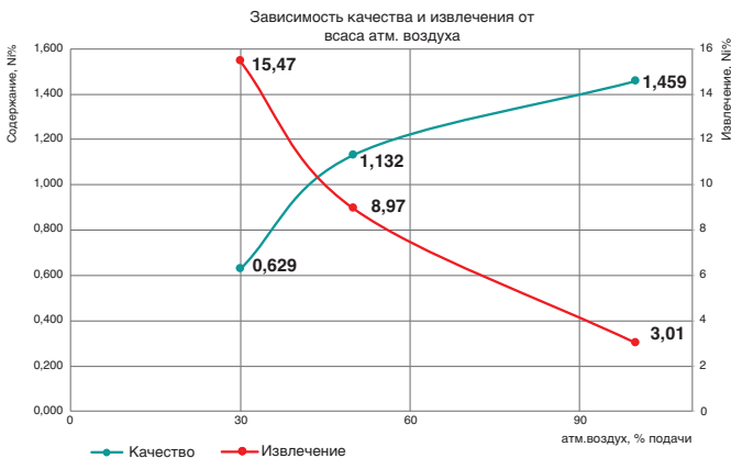
Рис. 3 Работа аэратора типа I. Влияние атмосферного воздуха на качество и извлечение
