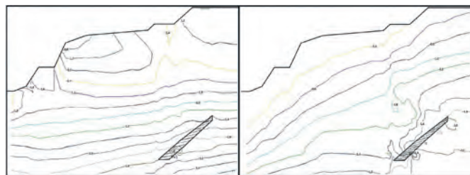
Рис. 4 Изолинии главных нормальных напряжений \sigma_1 и \sigma_2 в массиве пород, не тронутым подземными горными работами
