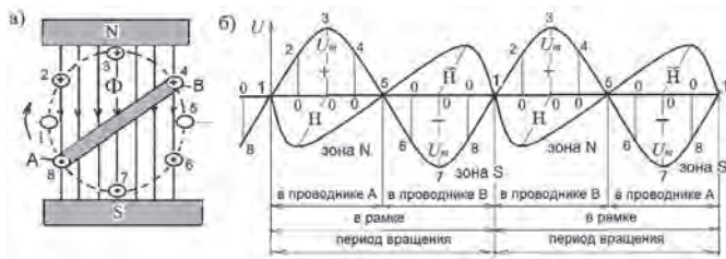
Рис. 1 Схема образования квантов электромагнитной энергии и напряжённости магнитного поля в проводнике рамки, вращающейся в магнитном поле, где а) – вращение рамки в магнитном поле; б) – характеристика квантов электромагнитной энергии, передаваемой проводнику за два периода вращения рамки; 1–8 – рассматриваемые точки положения проводников рамки относительно магнитного потока; U – напряжение индукции в проводнике; U_m – максимальная амплитуда напряжения индукции в проводнике рамки в точках 3 и 7; H – напряжённость магнитного поля проводника
