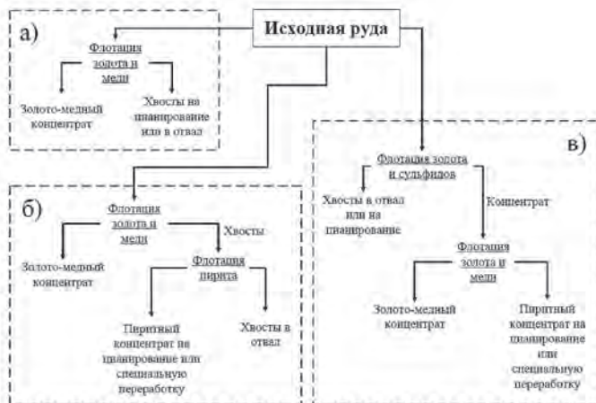
Рис. 1 Принципиальные схемы переработки золото-медных руд
