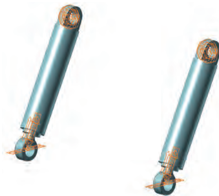
Рис. 9 Общий вид модели с шарнирами и силовыми связями левого и правого ГЦ грузовой платформы карьерного автосамосвала
