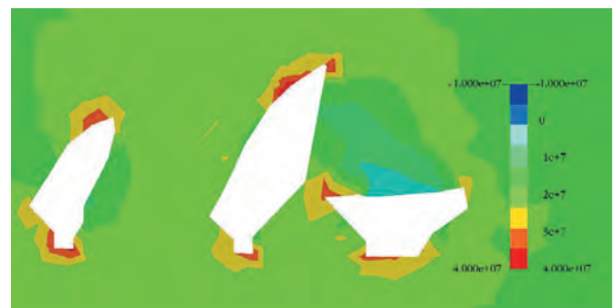
Рис. 3 Распределения максимальных \sigma_{\max} напряжений по разрезу 19 +5
