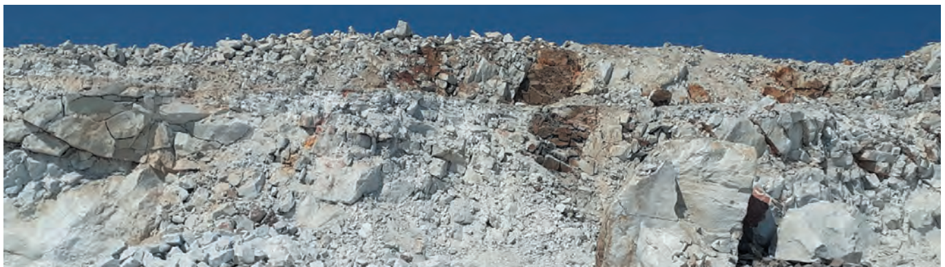
Рис. 2 Уступ карьера с выходом жёлтого (доломитизированного) мрамора
