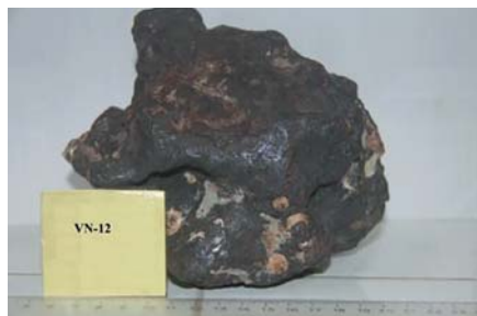
VN-12 Железомарганцевая руда коркового типа
