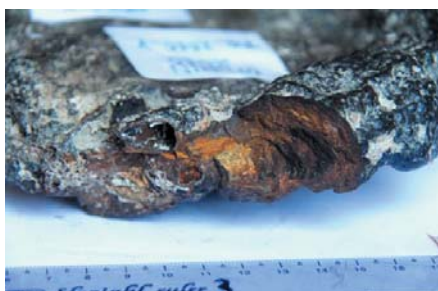
VN-14 Железомарганцевая руда коркового типа
