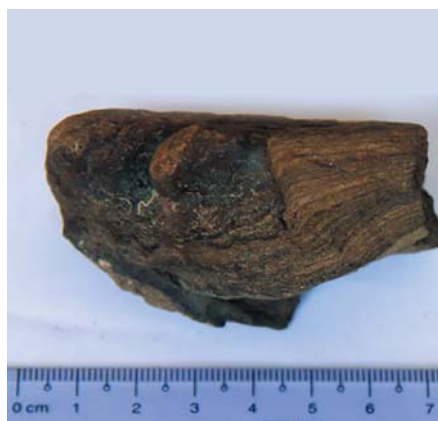
VN-1 Железомарганцевая руда коркового типа
