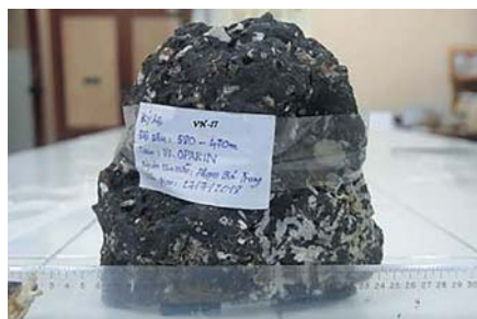
VN-17 Железомарганцевая руда коркового типа
