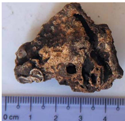
VN-2 Железомарганцевая руда коркового типа
