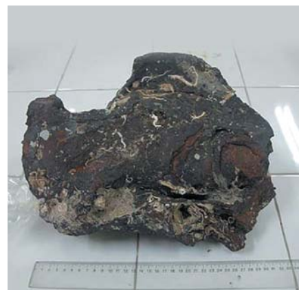
VN-7 Железомарганцевая руда (тип корки)
