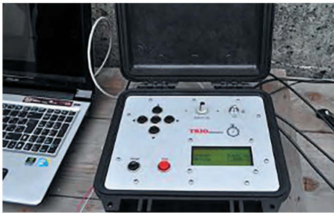
Рис. 3 Замер точности срабатывания электронных детонаторов
