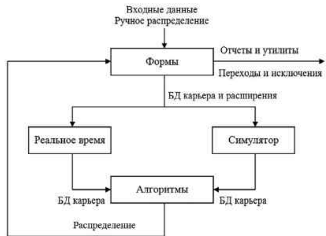
Рис. 3 Структурная схема системы DISPATCH [6] Схема процесса оперативного планирования работы карьера
