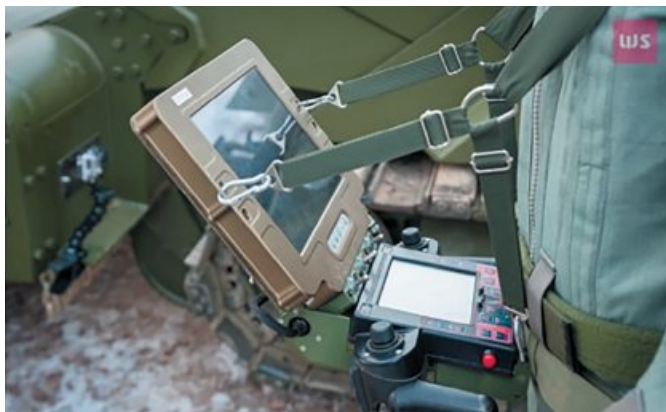
Рис. 19 Джойстиковый пульт управления
