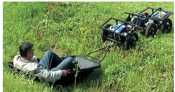
Рис. 8 Установка транспортировочной капсулы на БСАК
