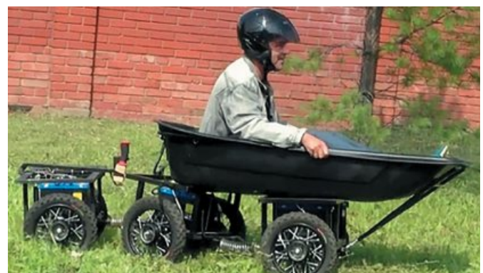
Рис. 9 Соединение транспортировочной капсулы с БСАК тягой
