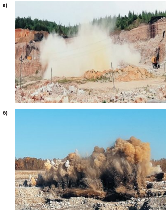
Рис. 6 Продукты детонации гранулита, изготовленного с применением поризующей эмульсии и топливной смеси на обводненном участке (а); пылегазовое облако при взрыве смеси АС/ДТ-6 на дизельном топливе и пористой селитре и гранипора (б)
