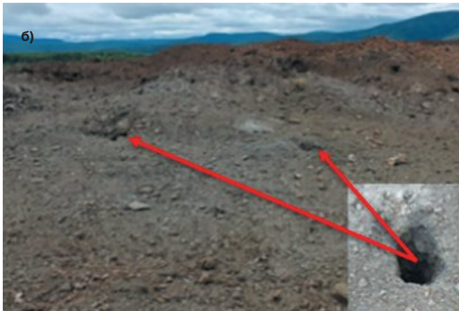
Рис. 3 Фото развала горной массы от взрыва блоков (а – первый взрывной блок, б – второй взрывной блок, где стрелками указаны прострелы скважин)
