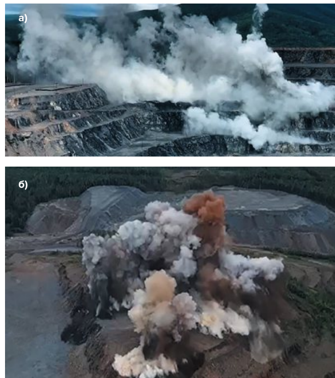
Рис. 2 Фото газового облака от взрыва блока (а – первый взрывной блок, б – второй)
