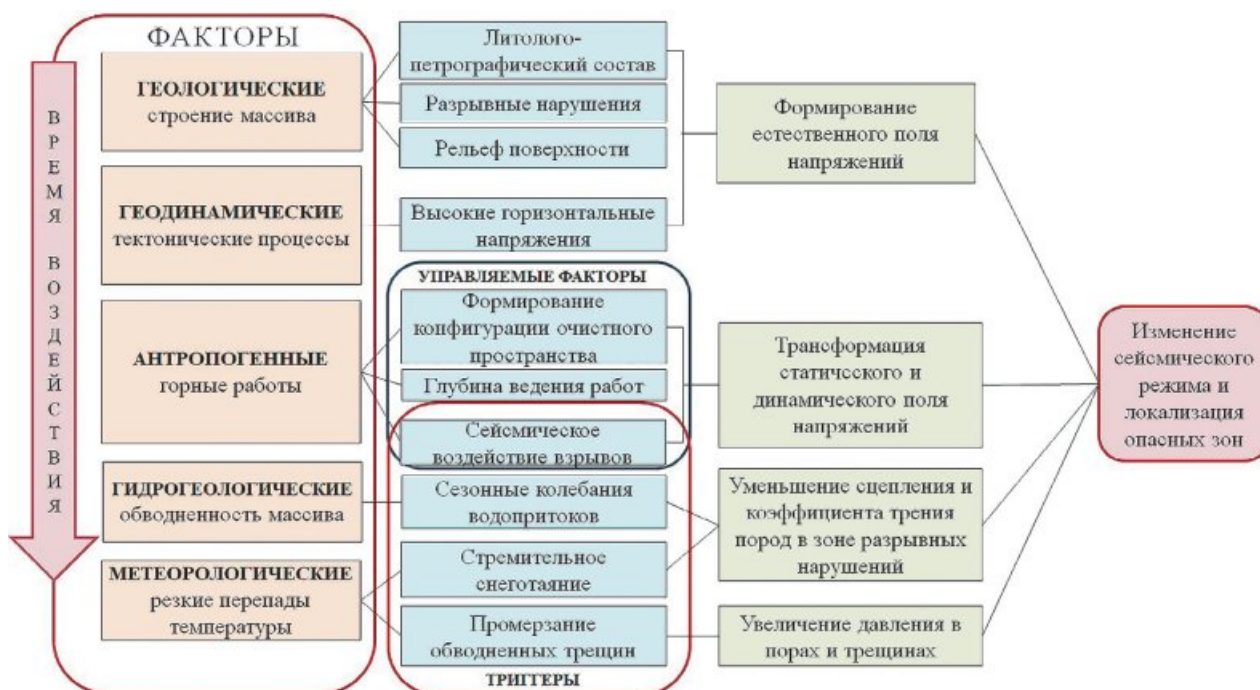
Рис. 4 Обобщающая схема факторов, влияющих на изменение сейсмической активности и формирование опасных зон
