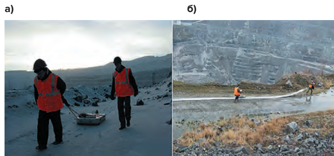
Рис. 2 Георадарные обследования участка борта карьера Железный АО «Ковдорский ГОК» с использованием георадарных комплексов: а – Ramac GPR/X3M; б – «ЛОЗА 1-Н»
