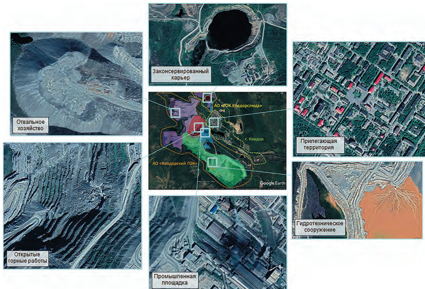
Рис. 2 Высокоточная мультиспектральная оптико-электронная космическая съемка территории горного производства и горнотехнических объектов
