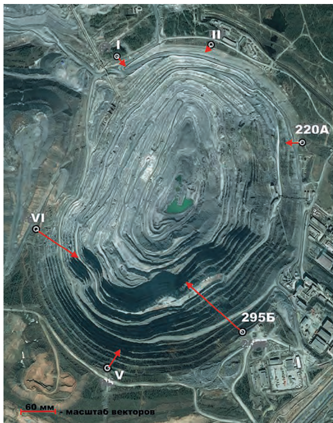
Рис. 1 Схема расположения фундаментальных пунктов в карьере «Железный» и результаты многолетних GPS-измерений
