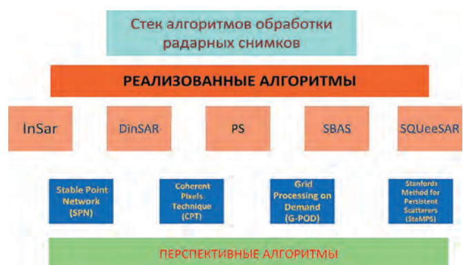
Рис. 2 Схема алгоритмов обработки радарной информации
