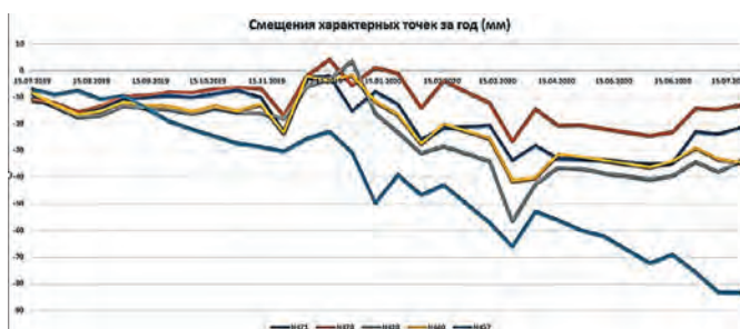
Рис. 4 Анализ смещений до и после оползня 2019–2020 гг. для угольного разреза
