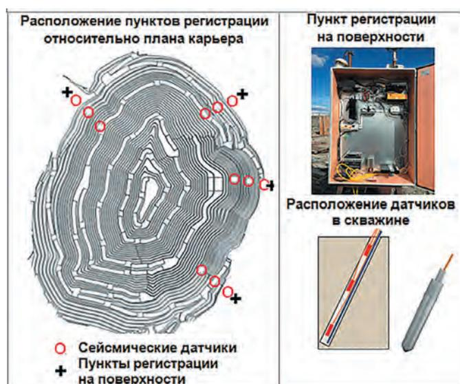
Рис. 1 Система сейсмического мониторинга бортов карьера рудника «Железный»
