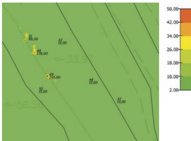
Рис. 3 Тепловые аномалии в зоне №1 с точками контактных замеров термометром
