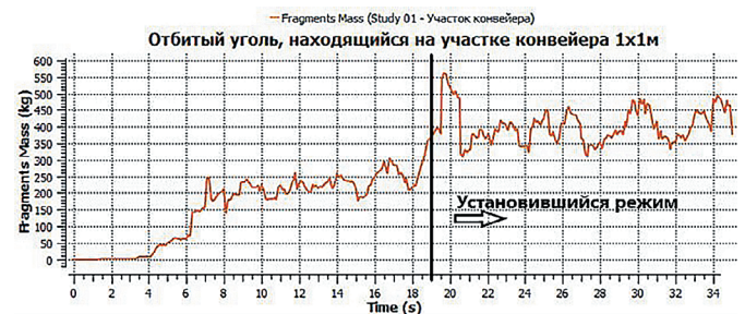
Рис. 3 График зависимости массы угля, находящегося на участке конвейера 1x1 м, от времени
