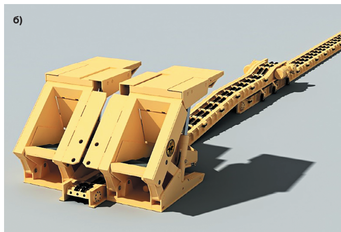
Рис. 1 Секция механизированной крепи с регулируемым выпуском угля на забойный скребковый конвейер для разработки пологих пластов (а) и крепь подэтажного обрушения для разработки крутых мощных угольных пластов (б)
