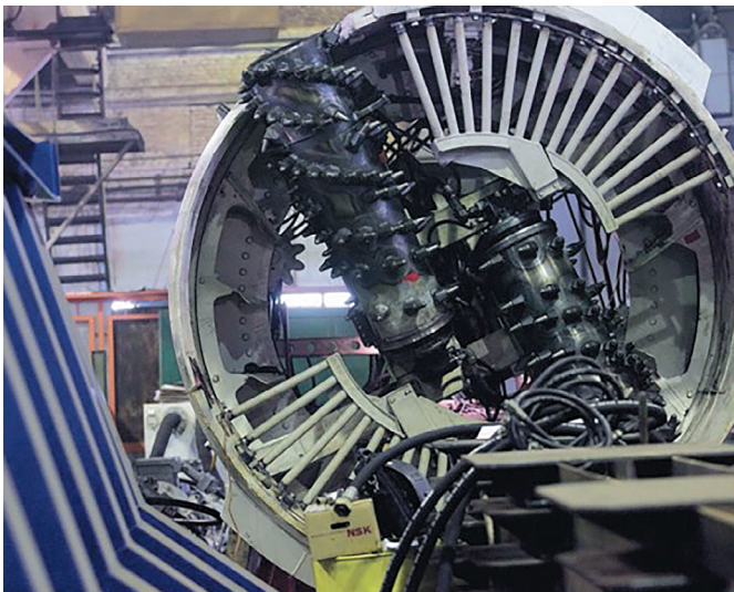
Рис. 2 Опытный образец ПА класса «Геоход» диаметром 3,2 м
