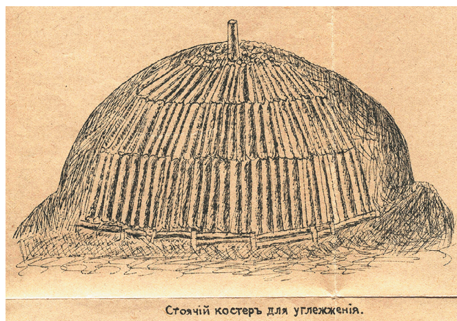
Рис. 4 Наиболее распространенный способ углежжения в России в XIX – начале XX вв. – «стоячий трех-ярусный костер» [5, приложение]
