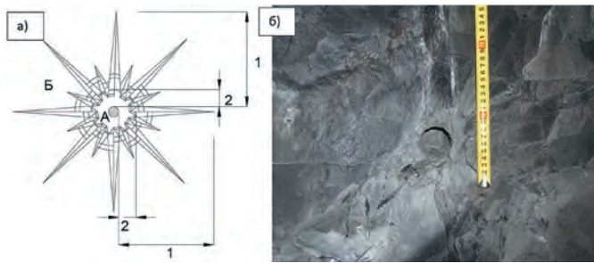
Рис. 1 а – схема зон механического действия от взрыва заряда в массиве (А – зона раздавливания; Б – зона радиальных трещин; 1 – радиус зоны распространения радиальных трещин; 2 – радиус зоны раздавливания («стакана»); б – фото области действия взрыва с зоной раздавливания и зоной радиальных трещин
