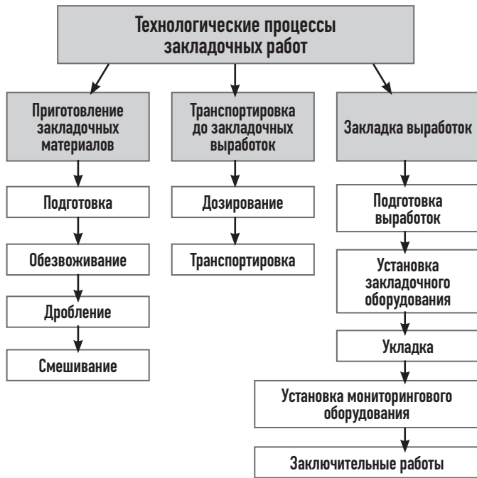
Рис. 1 Технологические процессы закладки выработанного пространства на калийных рудниках
