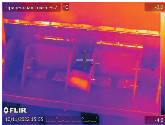
Рис. 4 Температура отбитой руды в дучке при выпуске, зафиксированная с помощью тепловизора FLIR SC660
