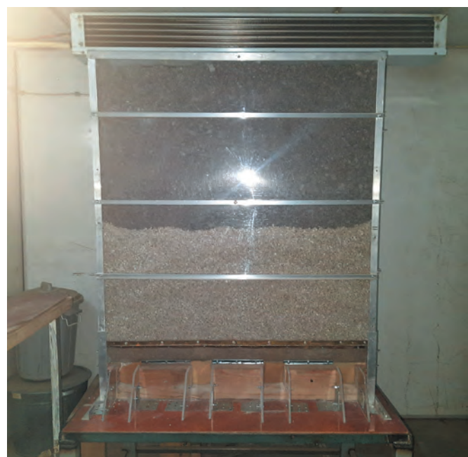
Рис. 3 Стенд в криокамере, подготовленный к проведению экспериментального выпуска руды
