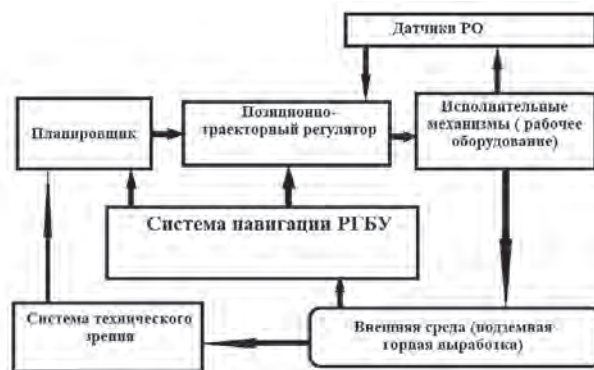
Рис. 7 Структурно-функциональная схема интеллектуальной позиционно-траекторной системы управления БРГБУ
