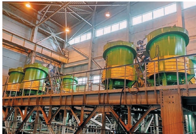
Рис. 3 Оснащение сепараторами МГС-2.0 технологической секции обогатительной фабрики ГРК «Быстринское» (ГМК «Норильский никель»)
