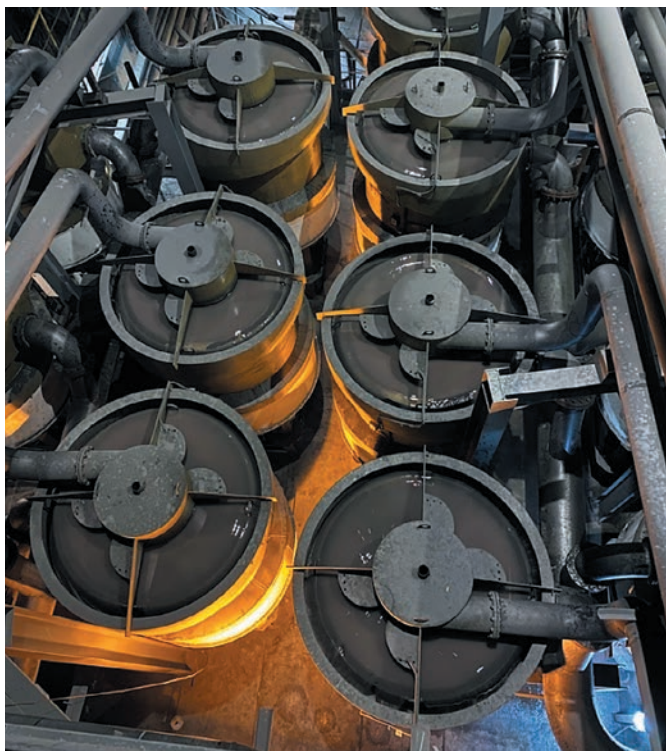
Рис. 2 Технологическая секция на Стойленском ГОКе (ПАО «НЛМК»), оснащенная магнитно-гравитационными сепараторами МГС-2.0
