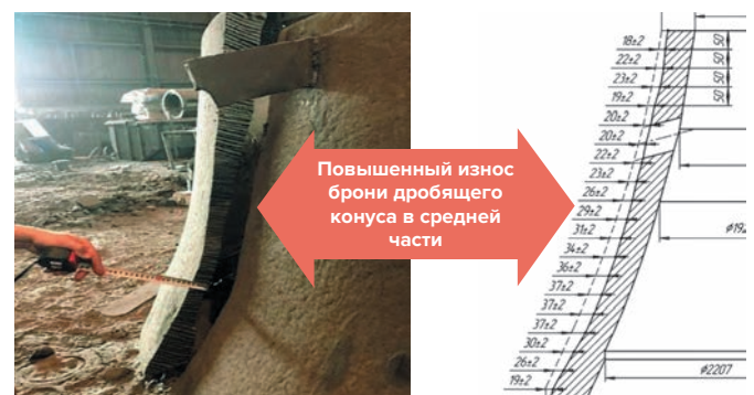
Рис. 1 Профиль изношенной брони в сопоставлении с новой для базовой модификации дробилки ККД-1500/180-2П а) изменение крупности продукта дробления по мере износа броней б) гранулометрический состав продукта дробления
