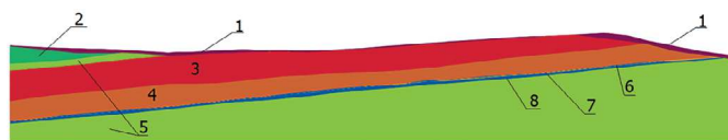
Рис. 3 Разрез модели по направлению Ю-С: 1 – четвертичные отложения; 2 – осадочные породы курейской свиты (мергель и аргиллит); 3 – интрузивные породы далдыканского комплекса; 4 – переслоения мергеля и ангидрита; 5 – осадочные породы зубовской свиты (мергель, ангидрит, гипс, аргиллит); 6 – ангидрит непродуктивный; 7 – мергель; 8 – продуктивный ангидрит
