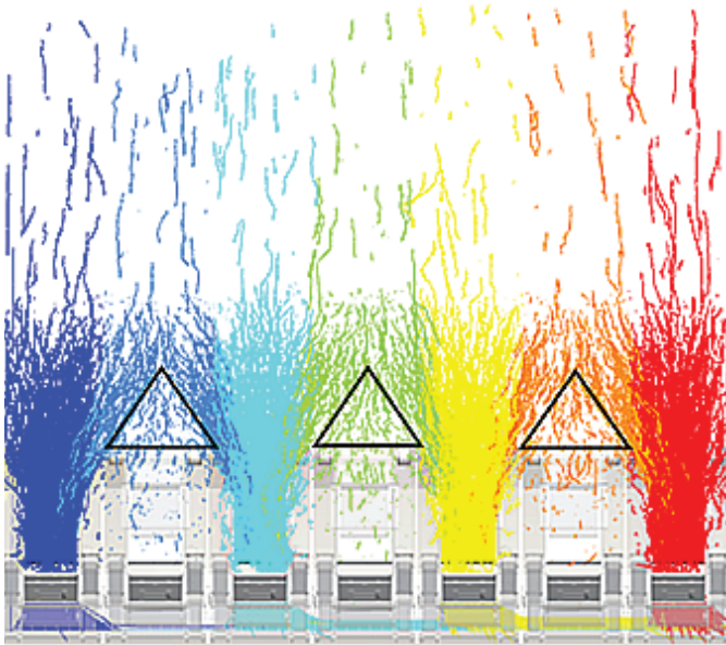
Рис. 5 Отображение результатов моделирования площадного режима выпуска угля с интервалом в одну секцию
