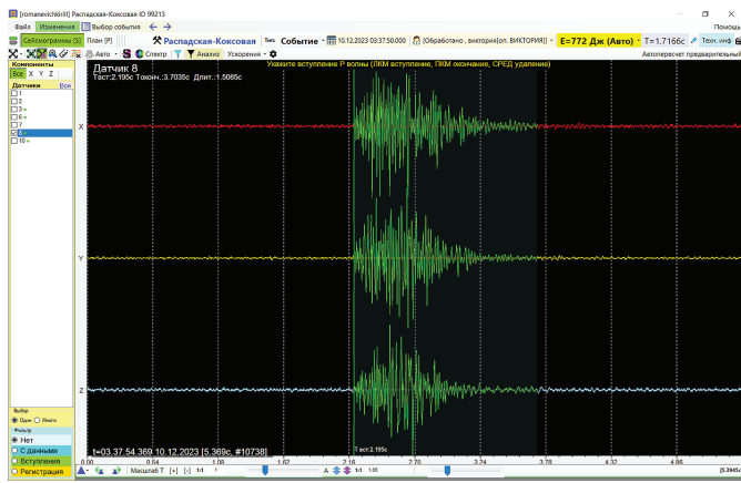
Рис. 2 Просмотр сейсмограмм датчиков по одному в районе позиции вступления для его точной корректировки в программе GITS2
