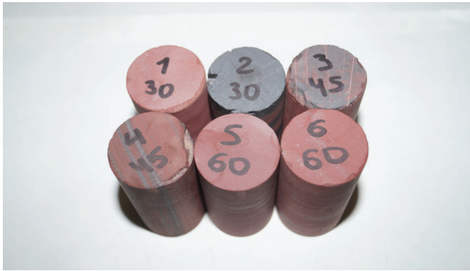
Рис. 2 Образцы исследуемых скальных пород (браунитовая руда) на трёхосное сжатие
