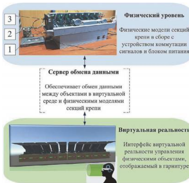
Рис. 3 Обобщенная структурная схема программного обмена данными между виртуальной реальностью и физическими объектами: 1 – контроллер реального времени; 2 – устройство коммутации сигналов для управления сервоприводами; 3 – физические модели секций
