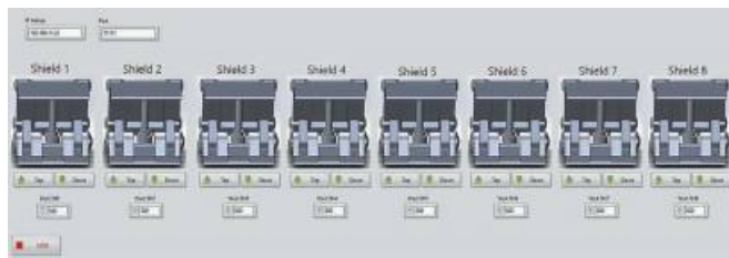
Рис. 2 Лицевая панель управления моделями секций механизированных крепи
