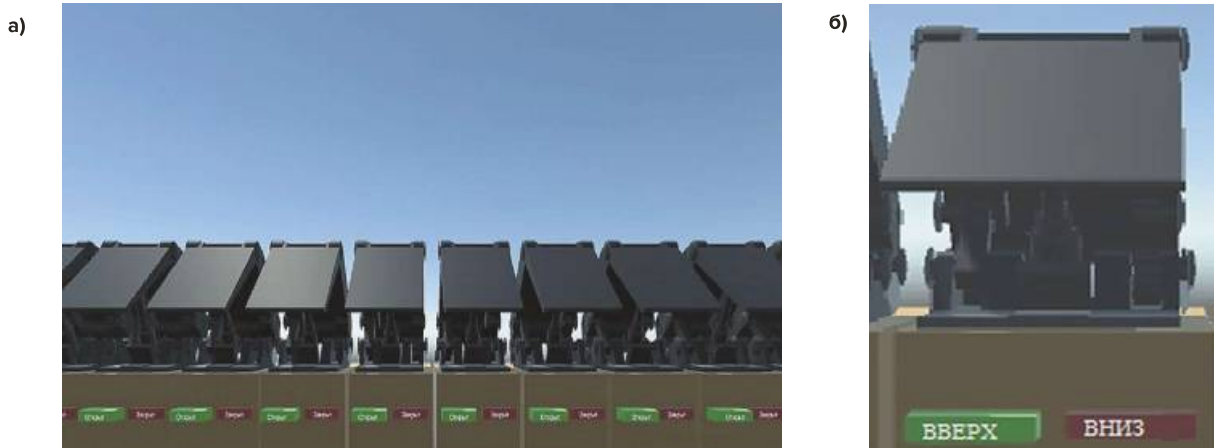
Рис. 4 Интерфейс управления физическими моделями секций механизированных крепей в виртуальной среде: а – интерфейс управления полным набором элементов имитационного модуля; б – единственный имитационный элемент
