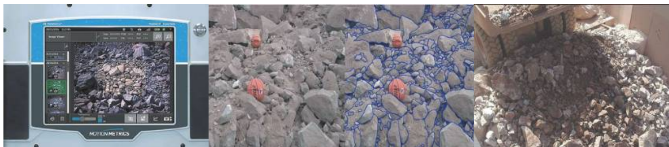
Рис. 1 Мобильное устройство компании Motion Metrics International Corp и изображения, полученные для анализа и их обрисовки с помощью программы Split-Desktop [15]
