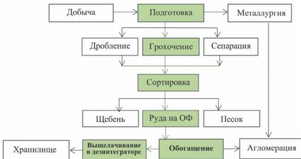
Рис. 3 Схема комбинированного обогащения руд цветных металлов
