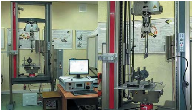
Рис. 4 Стенд для исследования процесса резания кембрийской глины одиночным резцом
