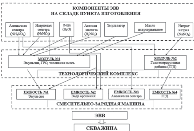
Рис. 3 Технологическая схема производства эмульсионных взрывчатых веществ «НПГМ» на полустационарном модуле АО «НИПИГОРМАШ»
