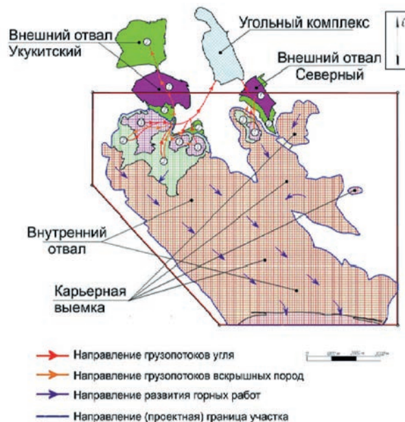
Рис. 1 Порядок отработки Северо-Западного участка Эльгинского каменноугольного месторождения и направления грузопотоков
