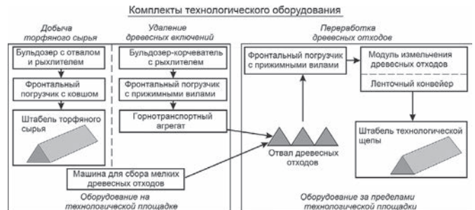
Рис. 3 Структурная схема мобильных комплектов оборудования
