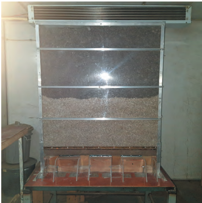
Рис. 2 Стенд для донного выпуска руды в криокамере
