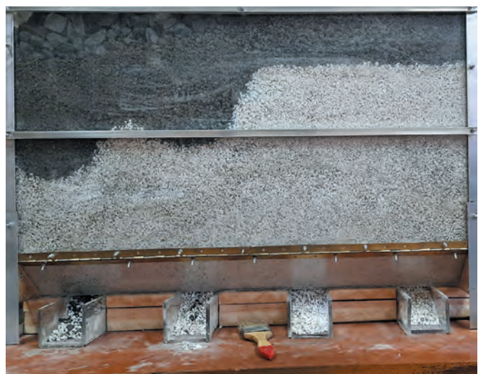
Рис. 4 Процесс выпуска руды в послойном режиме
