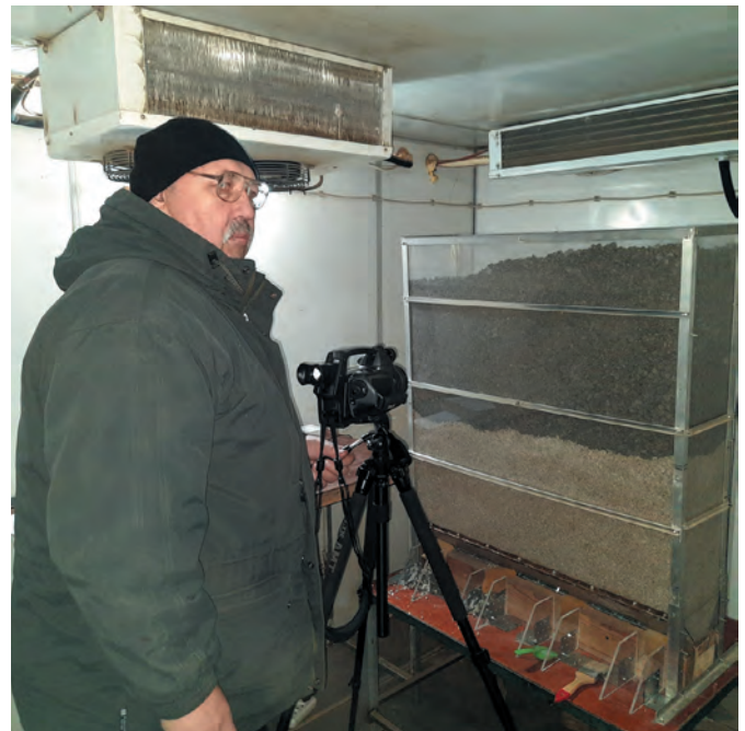
Рис. 3 Контроль температуры с помощью тепловизора FLIR SC660
