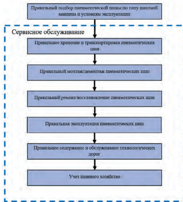
Рис. 1 Меры по увеличению ходимости пневматических шин шахтных машин
