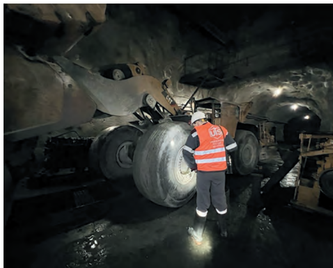
Рис. 2 Проверка внешнего вида пневматической шины погрузочно-доставочной машины
