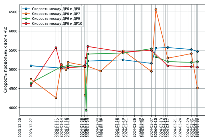
Рис. 6 Графики скоростей продольных волн между парами датчиков системы GITS от технологических взрывов, произведенных в нижней ограниченной области
