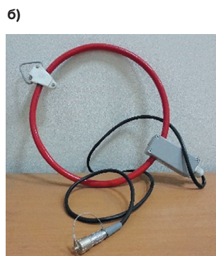
Рис. 6 Внешний вид ресивера комплекса ANGEL-M (а), передающей (б) и приёмной (в) антенн и акустического датчика (г) KD35
